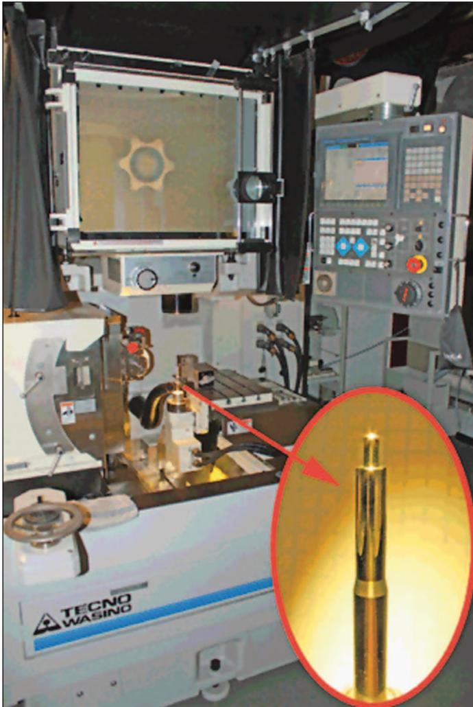
**Bearbeitung einer Prüflehre für Torx-Schraubköpfe auf einer CNC-gesteuerten projektionsoptischen Schleifmaschine, die kleinste Zustellbewegungen mit einer Schrittweite von lediglich 0,1 µm ausführen kann (Fotos: Klaus Vollrath)**
